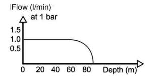
Was bedeutet das für das Tauchen mit einem Kreislaufgerät, bei der Verwendung eines Druckminderers mit konstantem Mitteldruck und Massenfluss? Dass die Einsatztiefe des Kreislaufgerätes auf die Tiefe begrenzt ist, wo der Umgebungsdruck den Mitteldruck des Druckminderers erreicht. In dieser Tiefe kann kein Sauerstoff in den Atemkreislauf strömen - weder über die Düse noch über die manuelle Sauerstoffzufuhr (Düse und manuelle Sauerstoffzufuhr werden von demselben Druckminderer gespeist).
