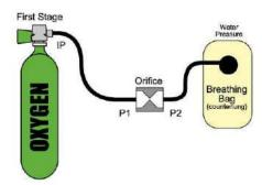
"Normale" Druckminderer zum Tauchen sind "kompensiert", d.h. so gebaut, dass sie den Umgebungsdruck "fühlen" und entsprechend den Mitteldruck anpassen. Dadurch ist der Unterschied zwischen Mitteldruck und Umgebungsdruck (während des Tauchgangs) immer gleich groß. Dies ist wichtig, damit die zweite Stufe, die normalerweise zum Tauchen verwendet wird, ihrem Zweck entsprechend funktioniert.
