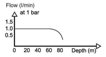
Je tiefer wir gehen, 70m, 80m,... umso größer wird der Umgebungsdruck des Wassers und nähert sich an P1, den Mitteldruck. Die Geschwindigkeit des Gases wird gemeinsam mit dem Massenfluss abnehmen bis 90 Meter erreicht sind. In dieser Tiefe sind der Umgebungsdruck und der Mitteldruck ausgeglichen (beide 10 Bar). Es gibt bei der Düse keinen Druckunterschied mehr und deswegen wird auch kein Gas strömen. Der Massenfluss ist Null.
