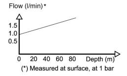
Wir merken also, dass je tiefer wir mit einem normalen Druckminderer an der Sauerstoffflasche tauchen, der Massenfluss des Gases (und der Volumenfluss gemessen bei 1Bar) zunimmt: wir haben keinen konstanten Massenfluss des Sauerstoffs.
