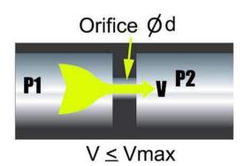
Wenn also die Bedingungen für das Erreichen der maximalen Geschwindigkeit gegeben sind, so wird, egal was man macht (mehr Druck vor dem Loch bzw. weniger Druck oder Vakuum hinter dem Loch), die Fließgeschwindigkeit des Gases durch das Loch konstant Vmax bleiben.
