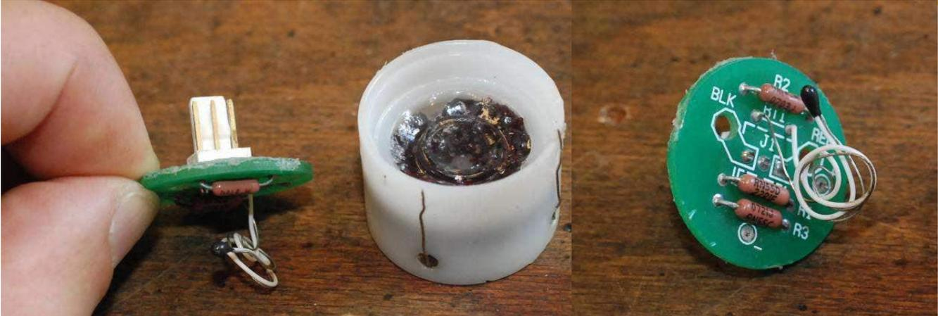
Wenn man die Platine entfernt, bemerkt man sofort die elektronischen Komponenten an der Unterseite. In der galvanischen Zelle (elektrochemischer Teil) sieht man eine flexible Membrane, die eine Flüssigkeit mit zwei Elektroden darin abdeckt.
